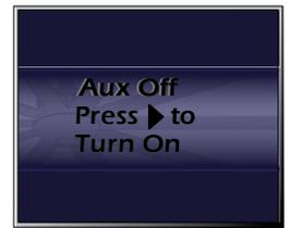
El segundo relé auxiliar o relé para iluminación está ubicado junto a la conexión de potencia principal y está diseñado para ser utilizado con dispositivos de mayor potencia. También es más fácil de controlar sin navegar por el menú, a través del botón dedicado.
