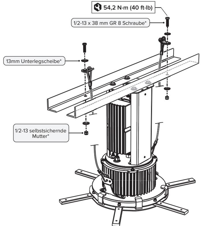
Schließen Sie die elektrische Installation ab, bevor Sie die unteren Sicherheitskabel installieren.
